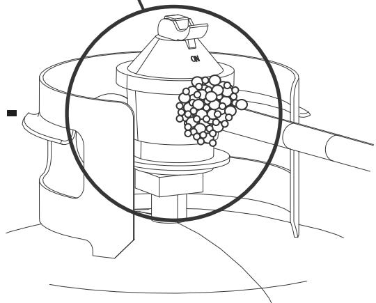
Проведите проверку утечек газа перед первым использованием. Проверку утечек газа необходимо проводить не реже одного раза в год, а также при каждой замене или подключении баллона.
